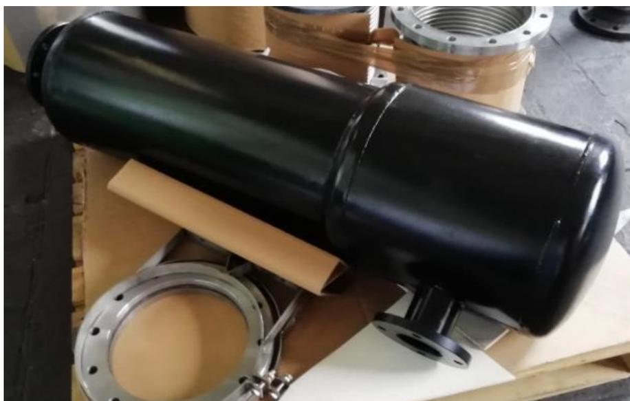
Silencieux RDS avec bride d'entrée DN80 PN6 et sortie DN100 PN6
